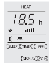
Слика 2 Тајмер за исклучување, при вклучен уред
