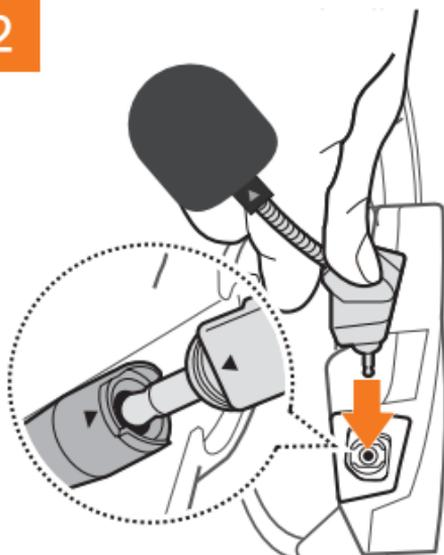
Instala el micrófono presionando firmemente en la zona marcada con el círculo naranja.
