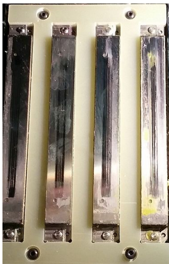
圖 4-72 安裝列印模組上的列印頭防濺板
