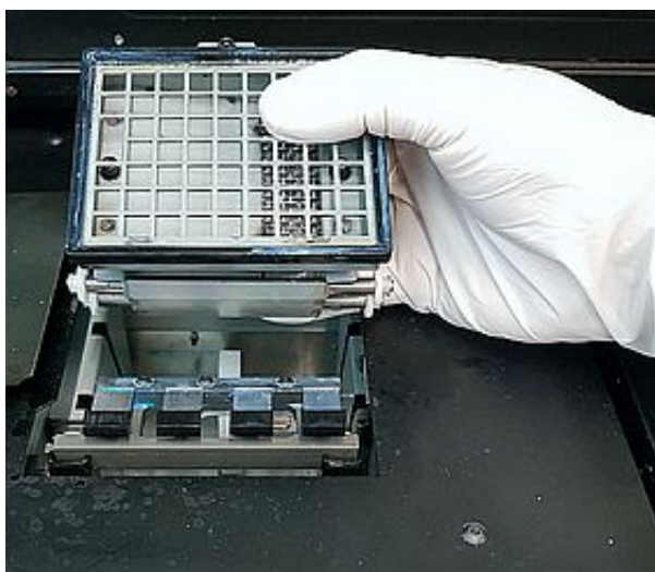
圖 4-46 移除清洗單元廢料收集器
