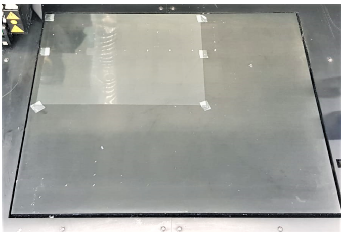
圖 4-169 將透明紙固定到托盤
