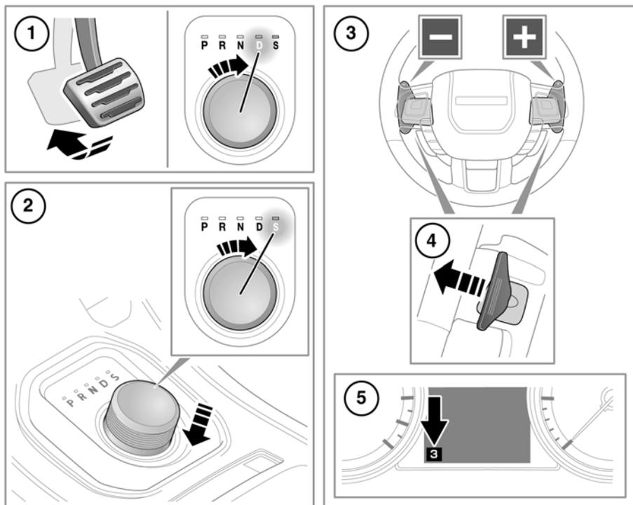
1. Чтобы выбрать диапазон **D** (Передний ход) или **R** (Задний ход), нажмите на педаль тормоза, а затем поверните селектор переключения передач. Загорится светодиод селектора.
