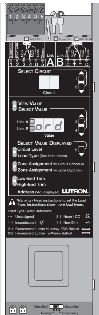
El interruptor está en la posición derecha (emergencia).
