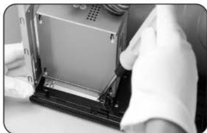
2 – Открутите два винта и разместите блок питания в нижнюю часть корпуса.
