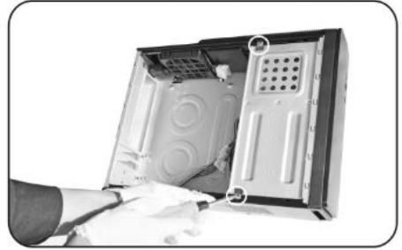
2 – Розмістити корпус так, щоб можливо було відкрутити гвинти, що фіксують 5,25" відсік.
