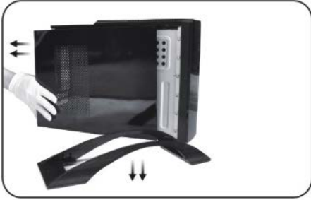
1 – Від'єднати основу для вертикального розміщення, відкрутити гвинти. Зняти бічну панель.
