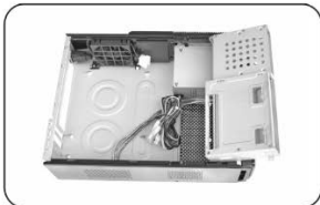
5 – Перевернути відсік 5,25" та підготувати для встановлення HDD.
