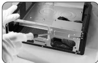
4 – Зафиксируйте блок питания винтами со стороны передней панели.
