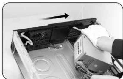
3 – Зафиксируйте кабели блока питания.
