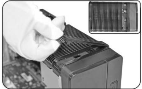
4 – При установці або знятті блока живлення необхідно зняти блокуючу частину на верхній панелі.
