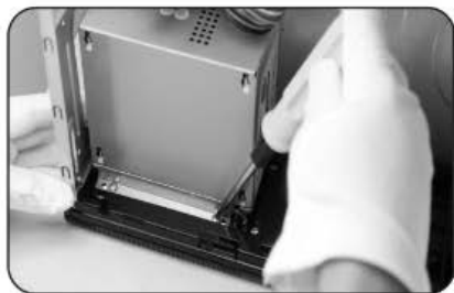
2 – Виверніть два гвинти та встановіть блок живлення в нижню частину корпуса.
