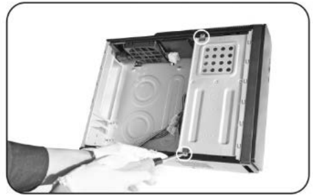
2 – Расположить корпус так, чтобы было возможно открутить винты, которые фиксируют отсек 5,25".
