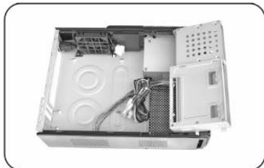
5 – Перевернуть отсек 5,25" и подготовить для установки HDD.
