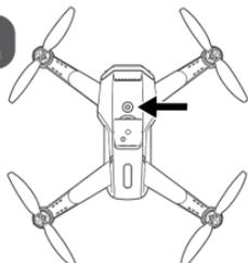
Cargue las baterías de la aeronave, luego pulse y mantenga pulsado el interruptor de encendido de la aeronave durante más de 3 segundos, la aeronave emitirá un sonido, y las luces delantera y trasera del trípode de la aeronave cambiarán de parpadeo rápido a parpadeo lento.
