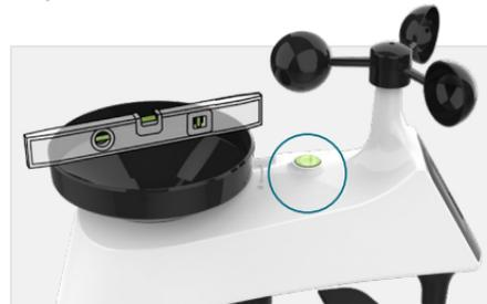
3. Vérifier le niveau à bulle intégré ou utiliser son propre niveau en le passant à travers l'entonnoir de pluviomètre pour s'assurer que le capteur est à niveau.
