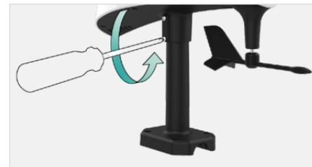
4. Fixer le capteur Cyclone au mât en serrant les vis situées sur le côté. Une fois les vis serrées, vérifier que le capteur est resté à niveau tout au long du processus d'installation.
