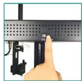
9. Vložte SD kartu do slotu čítačky kariet v tlačiarňi.
