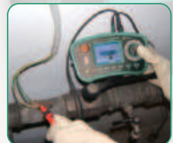
Continuity check of equipotential bonding
