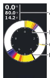
L'application Flasher affiche une vue de sondeur brute en temps réel couramment utilisée dans des scénarios tels que la pêche sur glace et la pêche verticale au jig.
