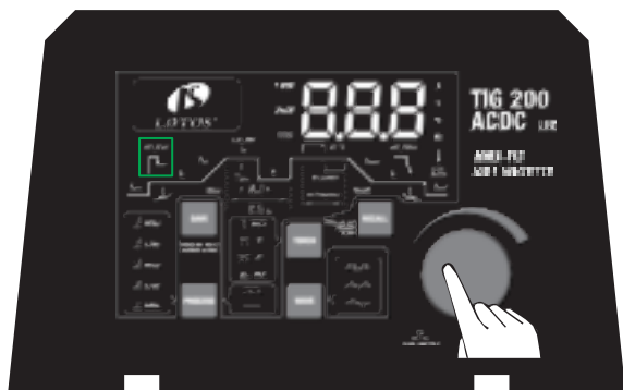
Step 3: Press the parameter knob to select the Hot-Start mode* .
