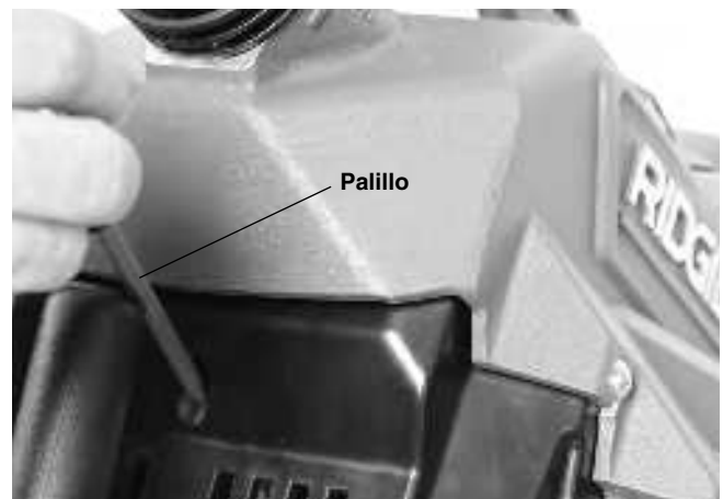
Figura 22 – Botón de reinicio del motor
