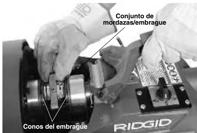
Figura 18 – Instalación del conjunto de mordazas/embrague
