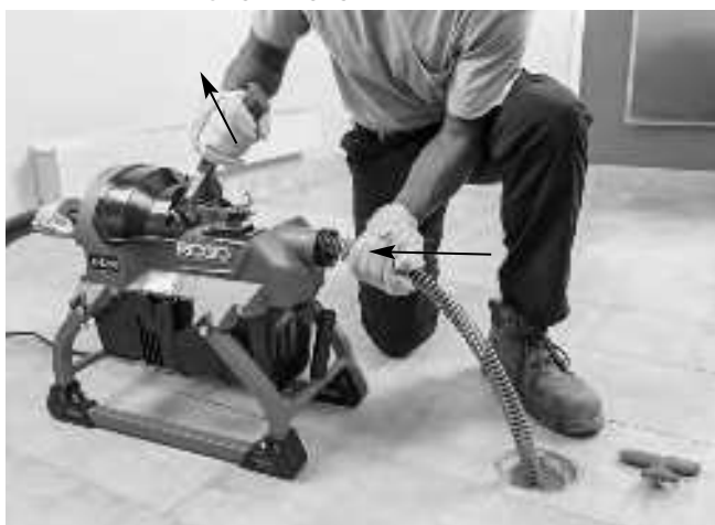
Figure 14B – Réintroduction du câble dans la machine avec embrayage désengagé et câble arrêté
