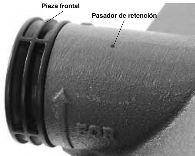
Figura 21 – Reemplazo de la pieza frontal
