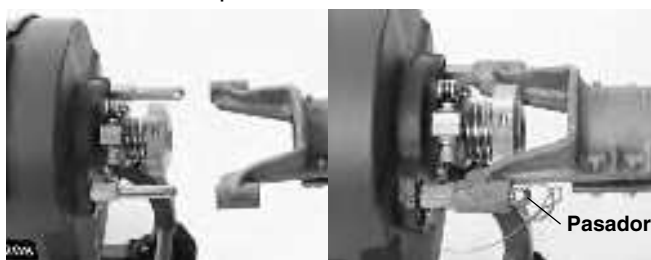
Figura 6 – Conexión de la manguera guía trasera
