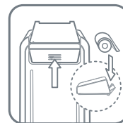
Pri výmene papi-erovej pásky otvorte kryt zatlačením na výstupky
