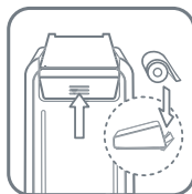
Za zamenjavo papir-nega zvitka pritisnite na zareze
