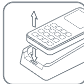
Trykk på knappen for å løfte ut terminalen
