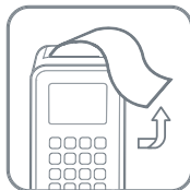
Odtrgajte potrdilo tako, da ga povlečete navzgor
