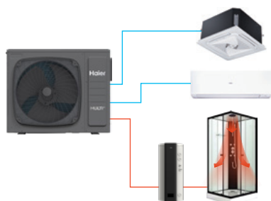
Szenario 5: Häusliches Warmwasser + AC Kühlung
