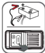
**Pas de lumières** : il indique que la batterie du véhicule peut être endommagée. Assurez-vous que la connexion est correcte, puis pressez le bouton « BOOST » sur le câble de booster, lumière verte allumera solidement, puis démarrez le véhicule pendant 30 secondes.
