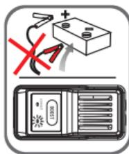
**Lumière verte clignote** : il indique que le voltage de batterie du véhicule est trop bas, pressez le bouton « BOOST » sur le câble de booster, attendez jusqu'à la lumière verte devient solide, puis démarrez le véhicule pendant 30 secondes.
