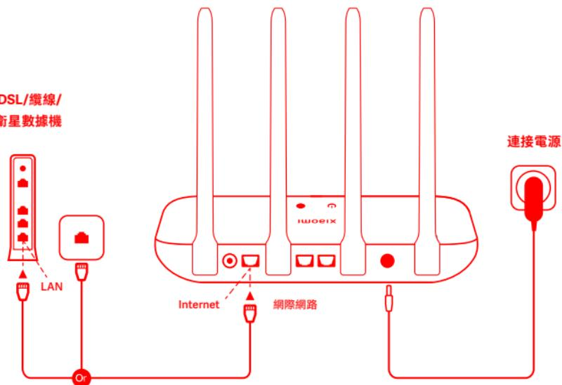
**開啟路由器電源，然後將網際網路 (WAN) 連接埠連接至 DSL/ 纜線/衛星數據機**
