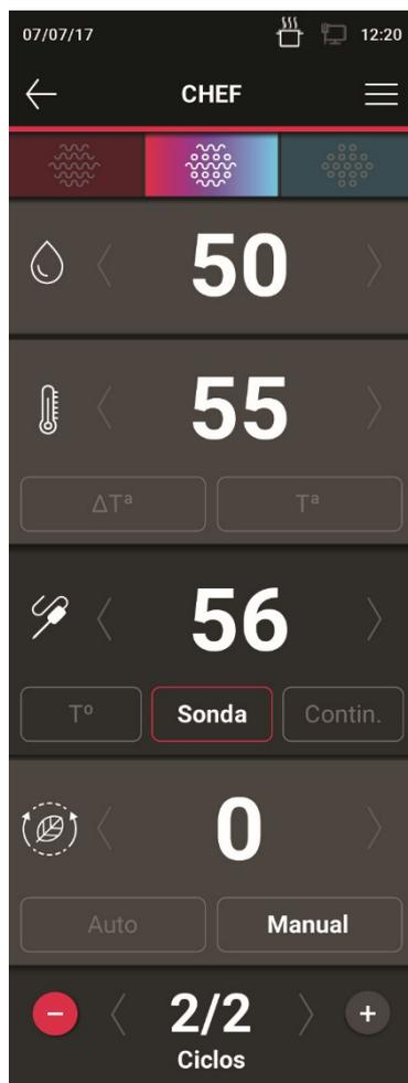
**Figura 16. Configuración de temperatura y control por sonda corazón**
