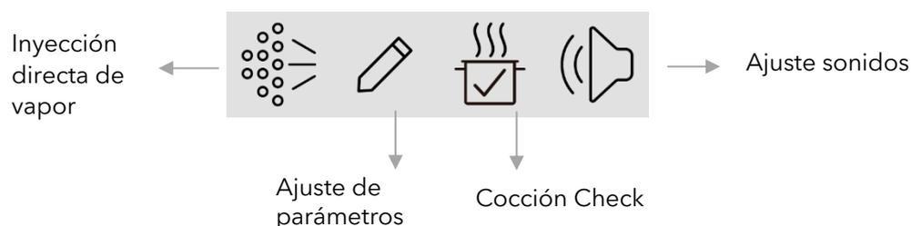
La inyección directa de vapor permite al usuario aumentar la humedad de la cámara en momentos puntuales durante la cocción. La duración de la inyección viene determinada por el tiempo que este botón esté pulsado.
