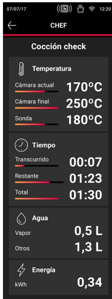
Figura 17. Ajuste de parámetros de cocción
