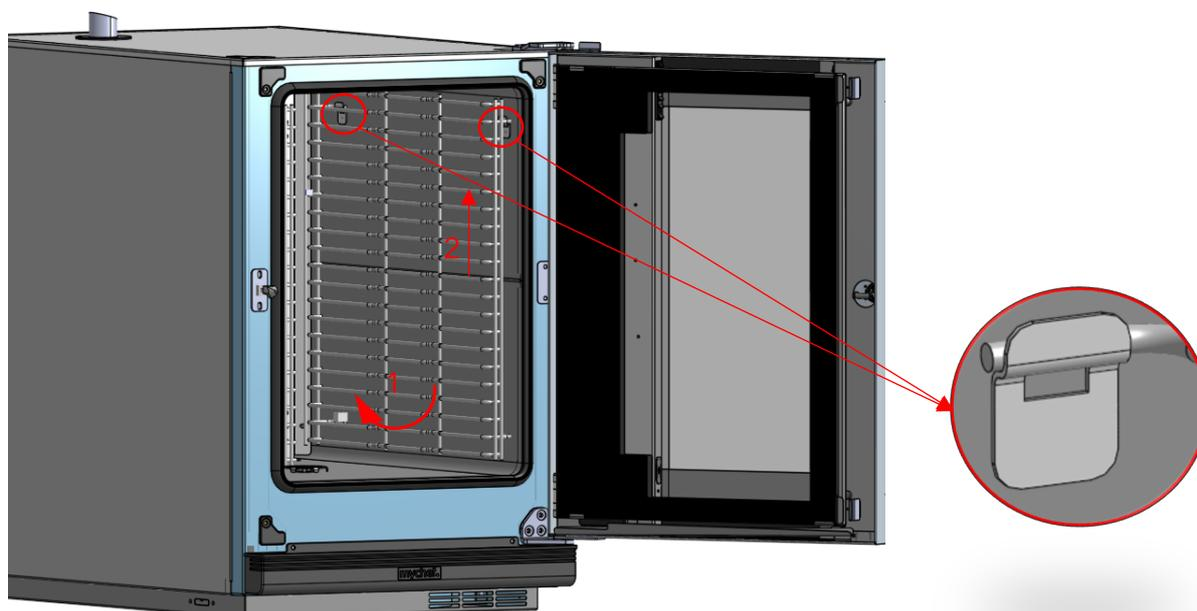
**Figura 58. Detalle proceso de retirar el cuerpo de guías**
