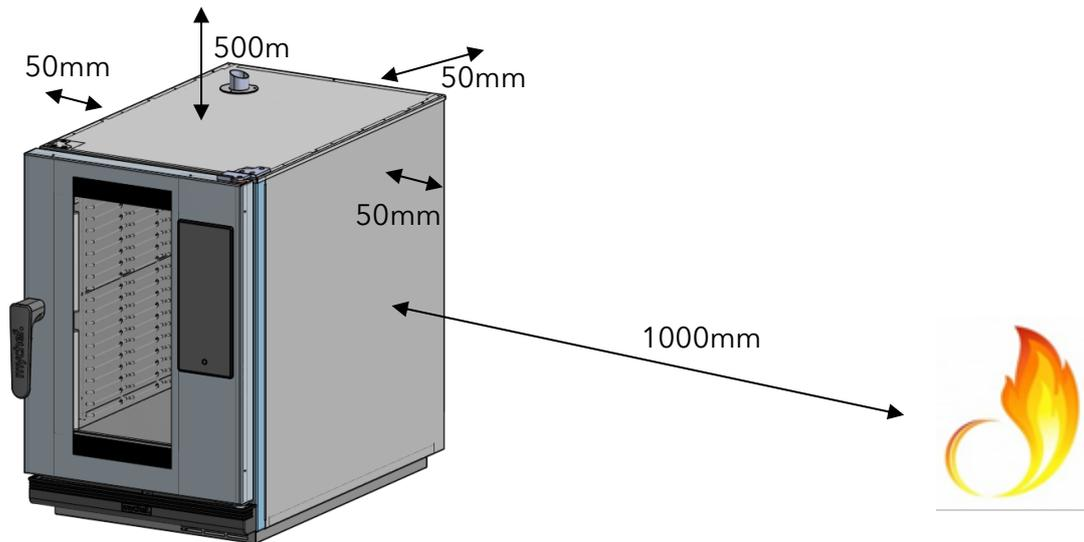
**Figura 2. Ejemplo de emplazamiento adecuado para instalación**
