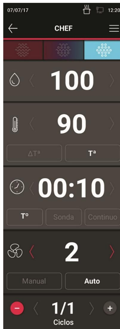
Figura 12. Ejemplo. Cocción 90°C en modo vapor durante 10 minutos
