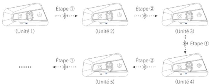
**Remarque:** Chaque unité B4FM ne peut être couplé qu' avec au maximum deux autres unités B4FM, c' est-à-dire deux unités sont connectées en série avant et arrière, pour réaliser la connexion de groupe de plusieurs unités. Par exemple, après le couplage de l' unité 3 séparément avec l' unité 2 et l' unité 4, sans voie libre, elle ne peut plus être couplée avec d' autre unité.
