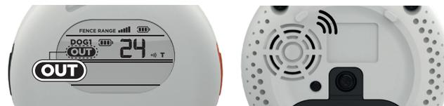
Lorsqu'un chien équipé du collier SMART FENCE sort des limites, un signal sonore retentit depuis la station de contrôle. Le système d'alerte est à deux niveaux : lorsque le chien est à la limite, et lorsqu'il la franchit.
