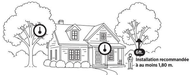
Utilisez le support mural et le câble de charge fournis pour installer la station de contrôle aussi haut que possible afin que le signal de clôture soit émis au-dessus de tous les objets.
