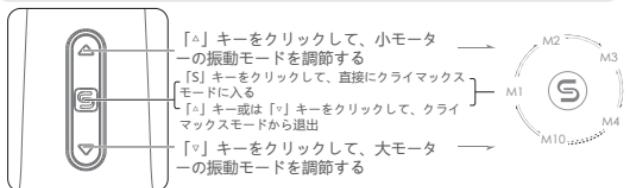
「▲」キーをクリックして、小モーターの振動モードを調節する
