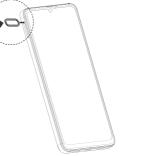
Coloque 1 o 2 tarietas nano-SIM en la bandeia SIM con los contactos dorados hacia abaio y los bordes con muescas coincidan con las posiciones en la bandeia SIM.
