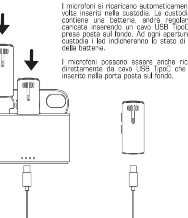
I microfoni si ricaricano automaticamente una volta inseriti nella custodia. La custodia, che contiene una batteria, andrà regolarmente caricata inserendo un cavo USB TipoC nella presa posta sul fondo. Ad ogni apertura della custodia i led indicheranno lo stato di carica della batteria.
