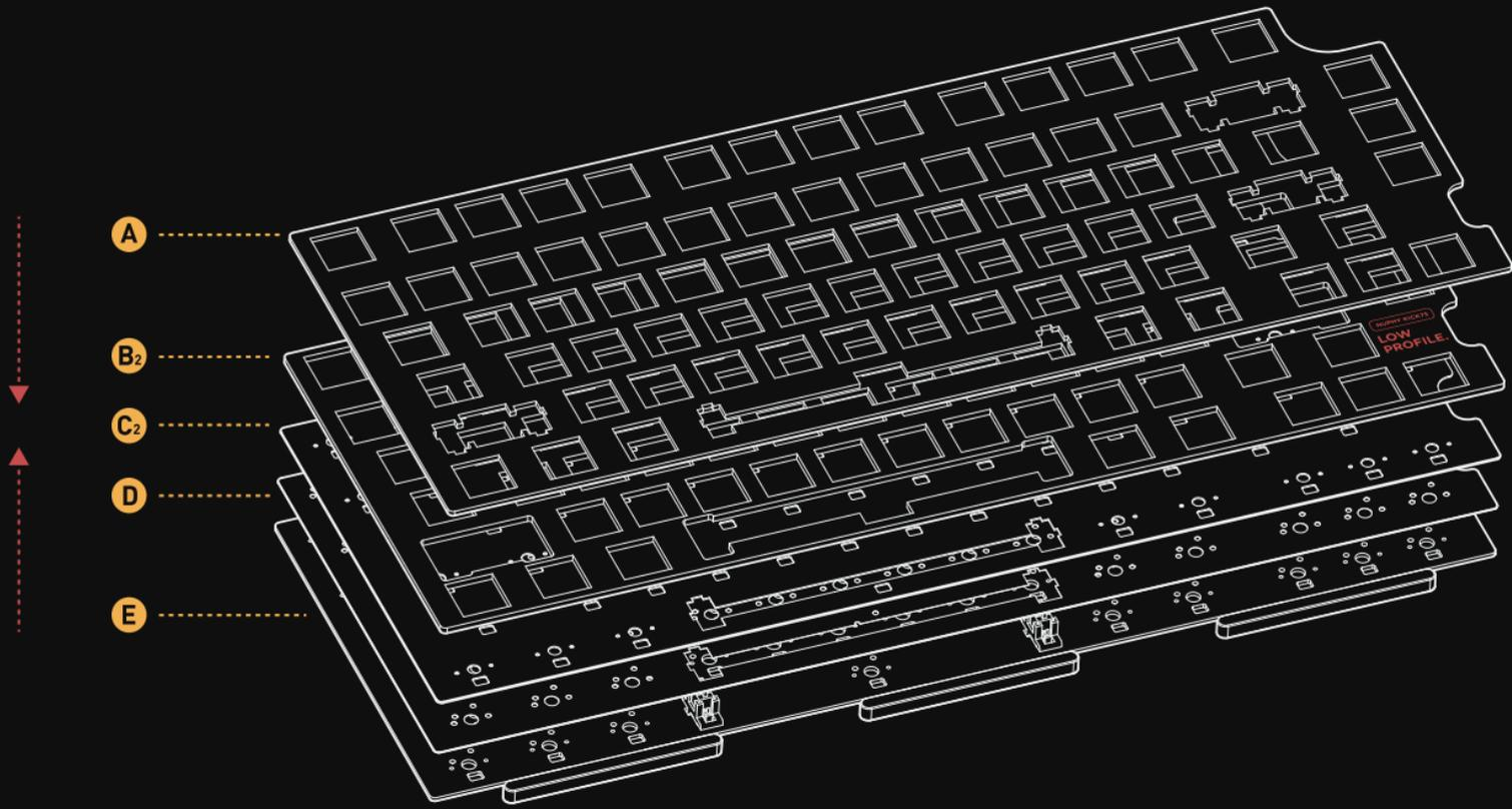
**B<sub>2</sub>** Plate foam in the accessory box / 配件盒中的夹心棉 / アクセサリーボックスに入っているフォームパッド / 액세서리 박스에 들어있는폼 패딩
