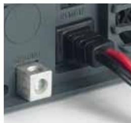
Rückseite mit Anschluss für Fernbedienung
