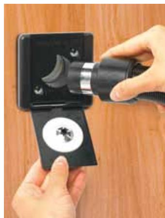
Wird der Saugschlauch angeschlossen, startet der Sauger automatisch.
