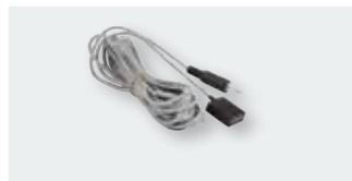
IU0U-Lader der Serie IU 152A bis IU 802A können zusätzlich mit dem Temperaturfühler ausgestattet werden, der als Zubehör lieferbar ist. Er sorgt für die Anpassung der Ladespannung an die jeweilige Batterietemperatur. So ist nicht nur eine bessere Vollladung bei Kälte gegeben, sondern auch ein Gasungsschutz bei hohen Temperaturen.
