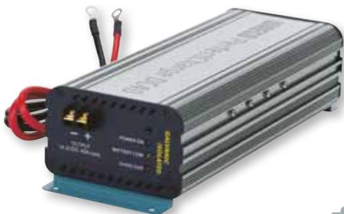
Ein Grund dafür sind zum Beispiel lange Zuleitungen mit zu geringem Querschnitt. Ein Ladewandler erhöht hier die Ladespannung auf 14,2 Volt und gewährleistet so eine optimale Ladung während der Fahrt. Über ein externes Steuersignal wie D+ der Lichtmaschine oder einen 12-Volt-Schalter kann der Wandler ein- und ausgeschaltet werden.
