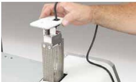
Der integrierte Breathe Easy™ Luftreiniger kann zum Auswechseln der UV-Lampe leicht entfernt werden.
