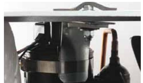
Der Kompressor wird zur Vermeidung von Vibrationen oben und unten fixiert.
