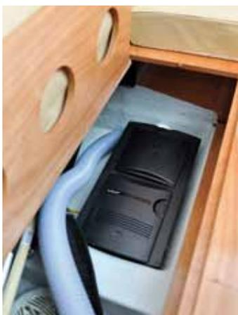
Nach außen unsichtbar: Der Sauger ist in einem Staufach untergebracht.
