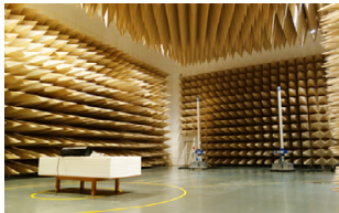
電磁波測定に使用する電波暗室
