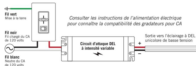
Lors de l'utilisation d'un gradateur pour CA de 120 volts, l'alimentation électrique DEL à intensité variable doit être directement relié à l'électricité résidentielle.
