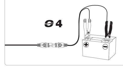
0-19 adapter with DIN/ISO 4165 plug • Adaptateur-prolongateur 0-19 avec fiche DIN/ISO 4165 • Adaptador-extensor 0-19 con enchufe DIN/ISO 4165 • 0-19 adaptador-extensor com plugue DIN/ISO 4165 • 0-19 Adapter-Extender mit DIN/ISO 4165 Stecker • 0-19 adapter-extender met DIN/ISO 4165-stekker • Adattatore-estensore 0-19 con spina DIN/ISO 4165 • 0-19 adapterförlängare med DIN/ISO 4165-kontakt • Adaptér-rozšíření 0-19 s konektorem DIN/ISO 4165
