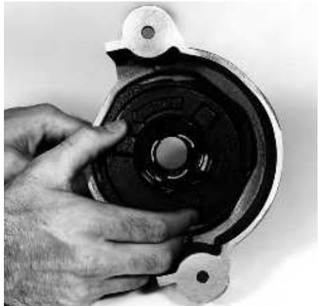
Figura 12 – Desmonte la tapa del juego de mordazas
