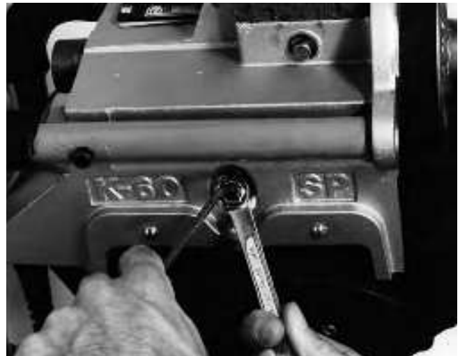
Figura 14 – Apriete la tuerca de inmovilización
