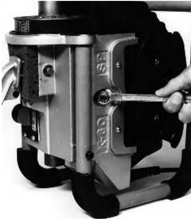
Figura 13 – Afloje la tuerca de inmovilización
