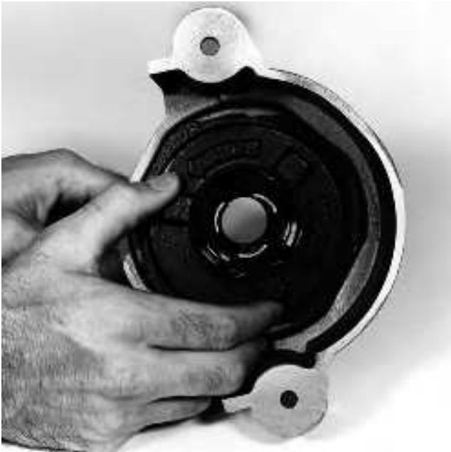
Figure 12 – Retrait du couvercle des mâchoires
