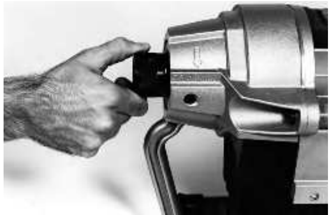
Figura 10 – Ajuste del conjunto de la mordaza
