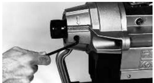
Figure 9 – Desserer la vis de blocage
