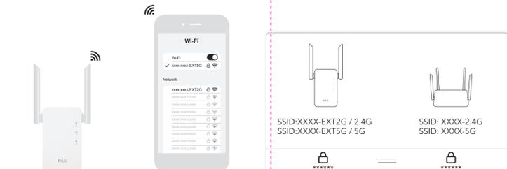
3 Conecte su dispositivo al Wi-Fi extendido e intente acceder a Internet. De forma predeterminada, la contraseña de la red extendida será la misma que la de la red original.
