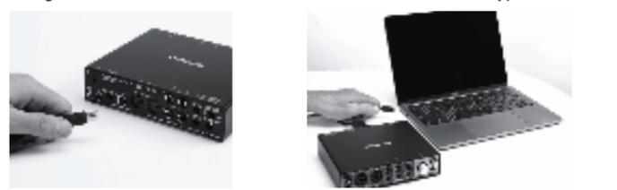
Potete usare il cavo da USB B ad A se il vostro computer non ha una porta USB Type-C\*. \* Potete usare un ulteriore hub USB e hub USB Type-C\* con alimentazione con l'interfaccia audio.
