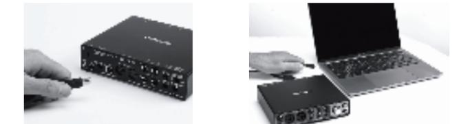
如果电脑没有 USB Type-C® 端口，则可以使用 USB B 转 USB A 线缆。
