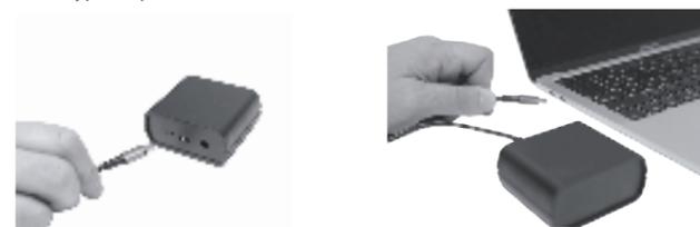
Puede usar un adaptador USB Type-C® a USB A si su ordenador no tiene puerto USB Type-C®.
