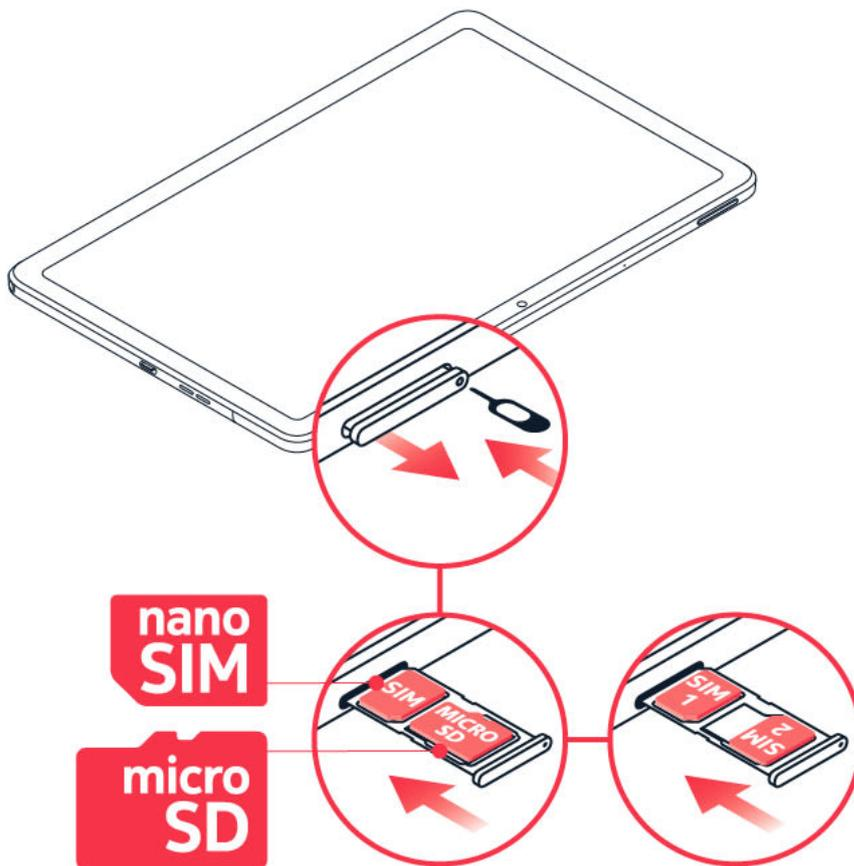
1. Abra la bandeja de la tarjeta SIM: inserte la herramienta especial en el orificio y extraiga la bandeja.
