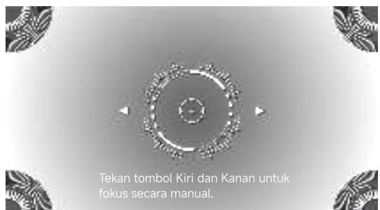
Catatan: Setelah fokus otomatis selesai, Anda juga dapat menekan tombol konfirmasi untuk masuk ke fokus manual dan menggunakan tombol navigasi pada remot kontrol untuk berpindah ke kiri dan ke kanan untuk penyetelan lebih lanjut.
