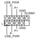
此主板上共有 2 个 USB 2.0 接脚。每个 USB 2.0 接头可以支持两个端口。
