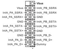
此主板上有一个 USB 3.2 Gen1 接脚。每个 USB 3.2 Gen1 接脚可以支持两个端口。
