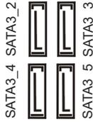
这六个 SATA3 接口支持最高 6.0 Gb/s 数据传输速率的内部存储设备的 SATA 数据线。
