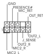
此接头用于将音频设备连接到前音频面板。
