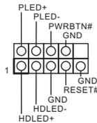
按照下面的针脚分配, 将机箱上的电源开关、重置开关和系统状态指示灯连接到此接脚。在连接线缆前请记下正负针脚。
