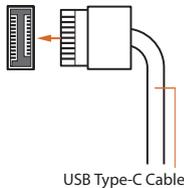
此主板上有一个前面板类型 C USB 3.2 Gen1 接脚。此接脚用于连接 USB 3.2 Gen1 模块以获得附加 USB 3.2 Gen1 端口。
