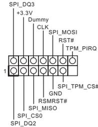
此接口支持 SPI Trusted Platform Module (信任平台模块, TPM) 系统, 可以安全地存储密钥、数字证书、密码和数据。TPM 系统也可以帮助增强网络安全, 保护数字身份并确保平台完整性。
