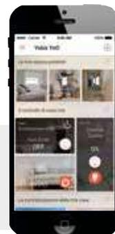
Per controllare l'impianto Yokis da smartphone e tablet, è sufficiente installare in casa **Yokishub**, il web server che permette di gestire i moduli Yokis utilizzando l'app **Yno**. Dopo aver salvato le configurazioni dell'impianto su **Yokishub**, il cliente potrà controllare e attivare l'impianto domotico Yokis della casa in modo semplice, personalizzato e sicuro utilizzando l'app **Yno** (scaricabile gratuitamente dagli store), sia in locale che da remoto.
