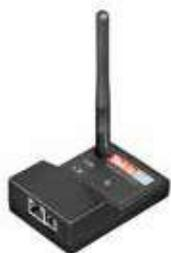
Programmabile da app Yokis Pro senza limiti, oppure in modalità manuale fino a un massimo di 10 ricevitori.
