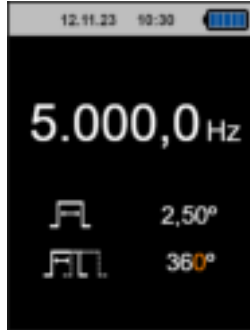
Abb. 7. Schnellmodus – Änderung Phasenverschiebung
