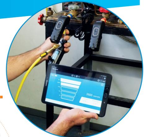
MESSEN DER EVAKUIERUNG MIT DER VAKUUMSONDE SI-RV3
