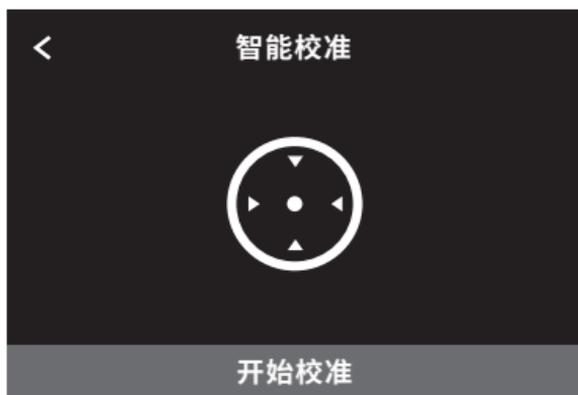
开始智能校准前请确保云台已完成调平，三轴锁定开关均已解锁，云台处于正立状态，水平放置于桌面上，校准过程中请勿干涉云台转动。
