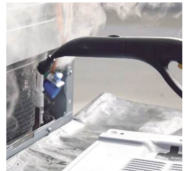
蒸氣清潔冷凝器
