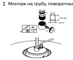
2 Монтаж на трубу, поворотный кронштейн
