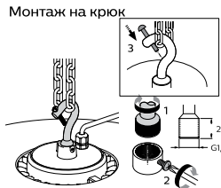
1 Монтаж на крюк
