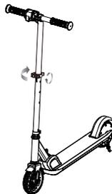
6. La tensión de la palanca de liberación rápida se puede ajustar apretando o aflojando manualmente el perno Allen. Cuidado de no apretarlo en exceso. Siempre debe poder abrir y cerrar la palanca de liberación rápida a mano y la barra en T debe deslizarse libremente cuando la liberación rápida esté abierta.
