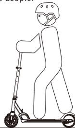
5. Para hacer paradas controladas, suelte el acelerador y aplique el freno presionando el freno del guardafangos trasero.
