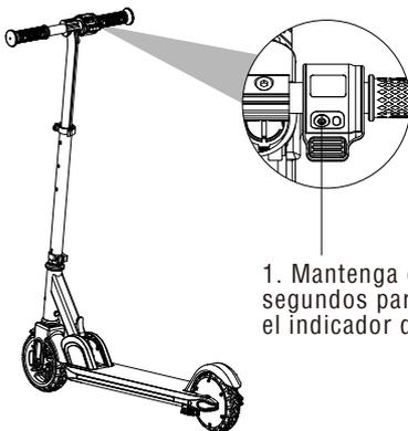
1. Mantenga oprimido este botón durante 2 segundos para encender el scooter. Compruebe el indicador de energía.
