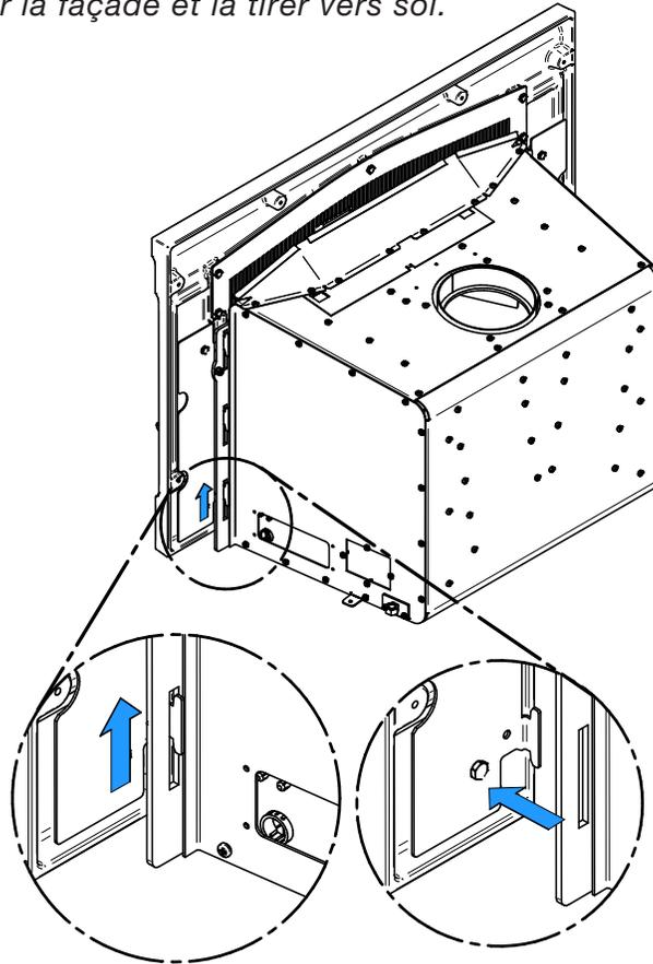
2. Cut the faceplate to the appropriate size and fix it on the insert faceplate with the screws **(A)** provided. / *Couper la façade aux dimensions requises et fixer sur la façade de l'encastable avec les vis **(A)** fournis.*
