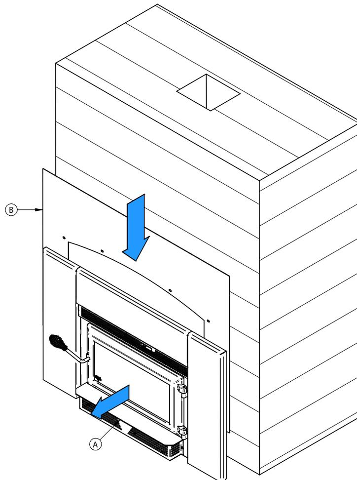
2. Push the insert (A) back against the masonry hearth so that the cuttable faceplate is clamped between the hearth and the insert. Make sure the faceplate is centered with the insert. / *Repousser l'encastrable (A) contre l'âtre de maçonnerie de façon que la façade taillable soit pris en serre entre l'âtre et le foyer. La façade doit être centrée avec le produit.*
