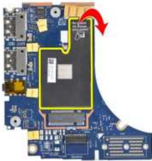
Figure 73. Latitude 7450 2-in-1 4G WWAN Configuration (Gasket Sticker)
