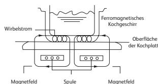
versorgt wird. Durch den Kontakt mit dem Kochgeschirrboden werden daraufhin die Lebensmittel erwärmt.
