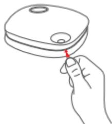
②. Utiliza un clip para retirar la batería y a continuación, coloca una nueva, colocando la batería con el lado positivo hacia arriba.
