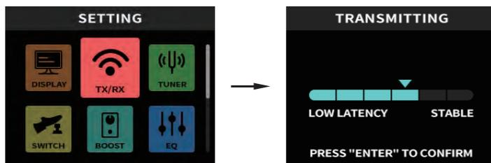
In der ganz linken Position „**LOW LATENCY**“ wird die Übertragungslatenz auf ein Minimum reduziert (ca. 3,6 ms).
