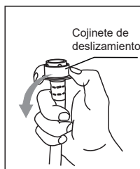
5. Presione el cojinete de deslizamiento, inserte la manguera de entrada dentro de la base de conexión
