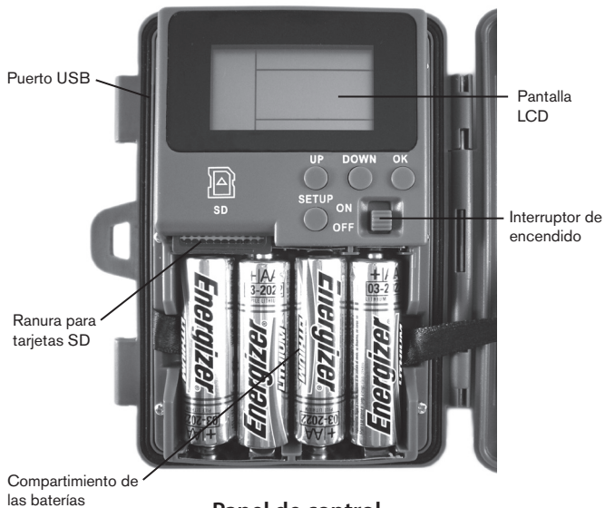
Panel de control (frontal desbloqueado y abierto)
