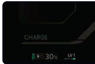
Il livello di frenata rigenerativa selezionato viene visualizzato sul quadro strumenti. L'impostazione iniziale del livello di frenata rigenerativa varierà in base alla modalità di guida selezionata.
