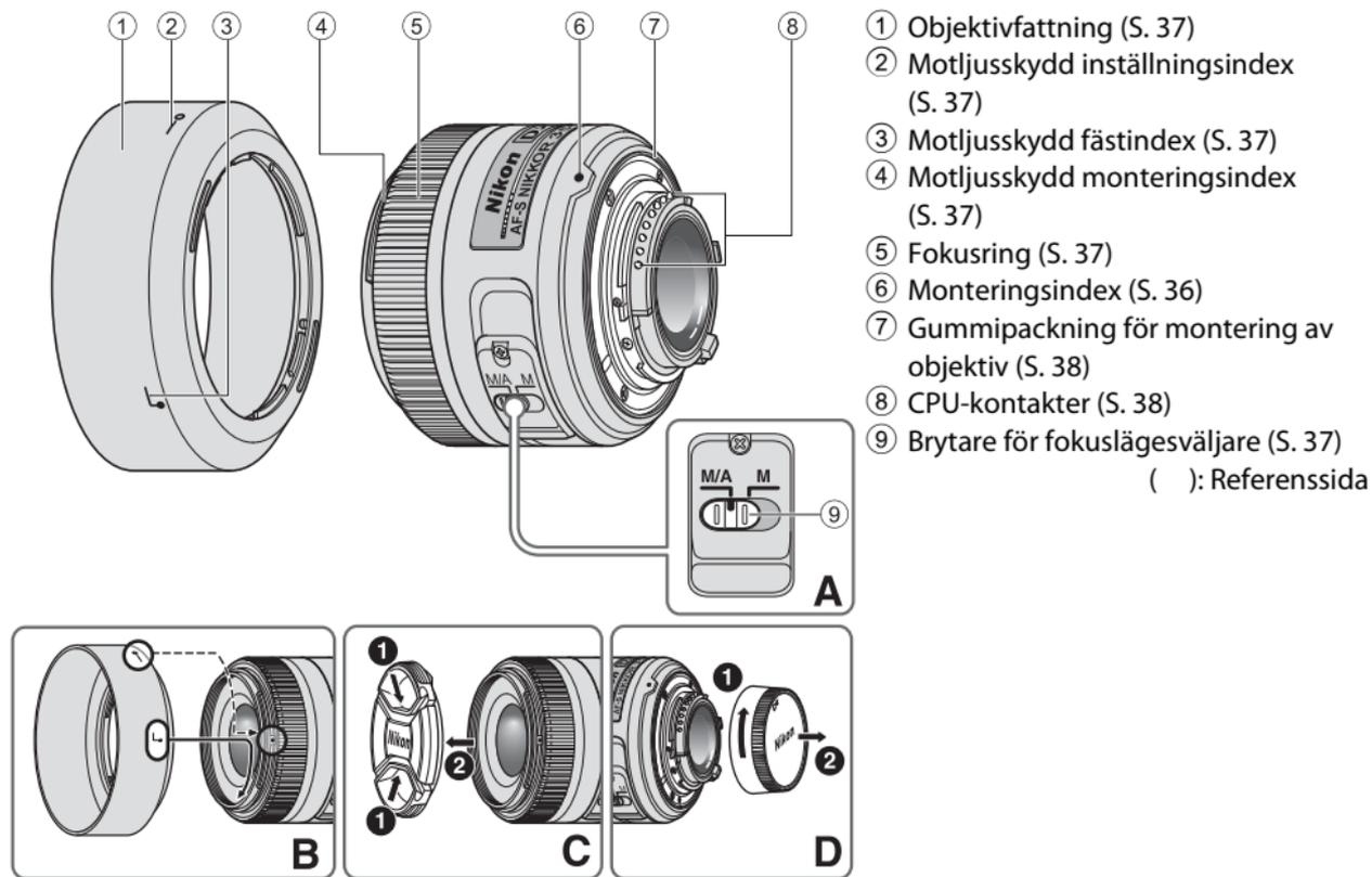
Tack för att du köpte objektivet AF-S DX NIKKOR 35mm f/1,8G. DX Nikkor-objektiv är speciellt konstruerade att användas tillsammans med kameror av typen Nikon digital-SLR (Nikon DX-format), exempelvis D300 och D90. Vid montering på kameror i Nikon DX-format motsvarar objektivets bildvinkel ungefär 1,5x brännvidden i 35mm format. Innan du använder objektivet ska du läsa de här instruktionerna och kamerans *Användarhandbok*.
